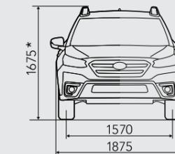
\* El acabado FIELD tiene una altura de 1670 mm.
